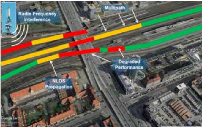
Principales efectos locales negativos para se ales GNSS en v as de tren. Fuente: ERSAT GGC project.
