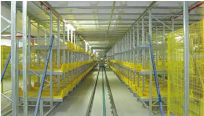
Línea de almacenes de equipajes tempranos, con operación mediante transelevadores, en el aeropuerto de Alicante.
